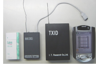
図 1 受信機, RFID タグ及び携帯端末 (PDA)
