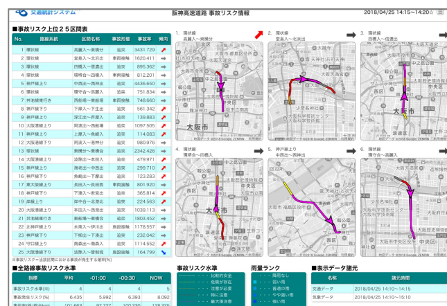
図-4 管制室に設置したリアルタイム事故リスク表示端末画面
