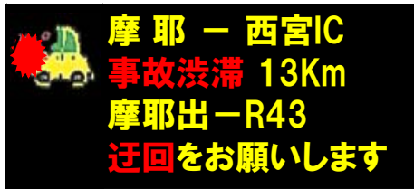
上段: 障害渋滞情報(渋滞区間・原因・渋滞長) 下段: 迂回経路情報、迂回推奨メッセージ
