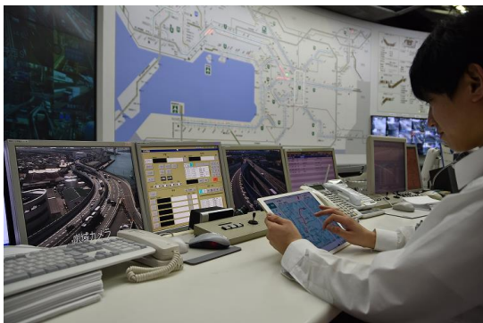
図-7 事故リスク表示端末を使用する管制員
