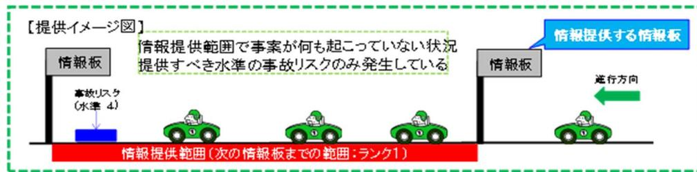
図-5 道路情報板への交通事故リスク情報提供イメージ
